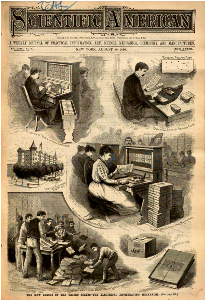
Abb. 33: Der elektrische Zählmechanismus bei der Volkszählung in den USA im Jahr 1890
