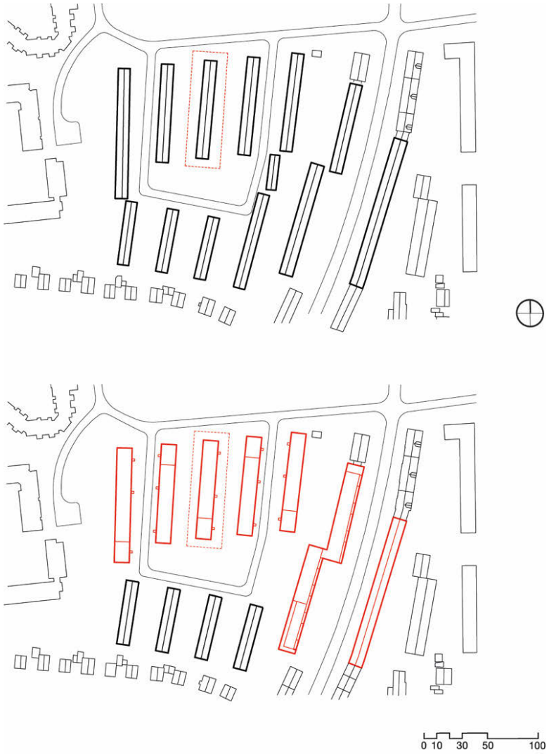
Abb. 12: Lagepläne Bestand – Nachverdichtung, Attenkoferstraße
