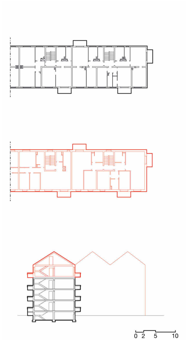
Abb. 39: Grundrisse & Schnitte Bestand – Aufstockung & Anbau 2, Ziekowkiez
