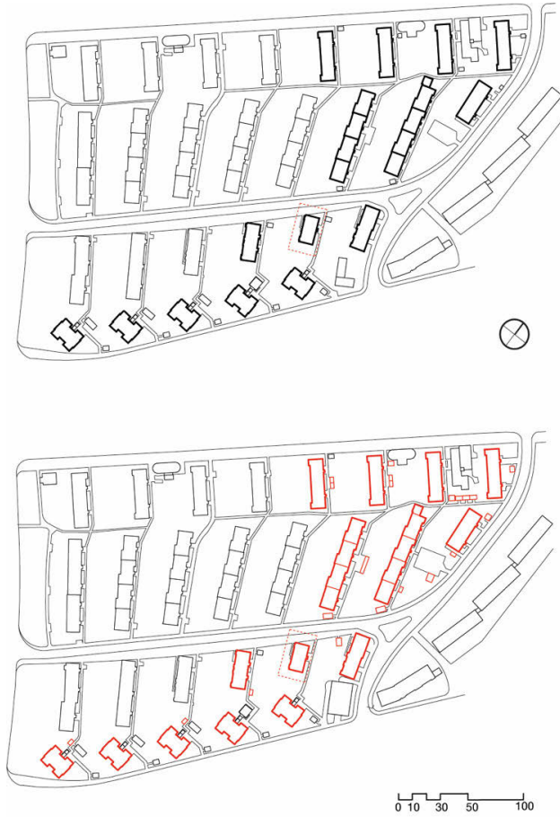
Abb. 8: Lagepläne Bestand – Nachverdichtung, Fritz-Kissel-Siedlung
