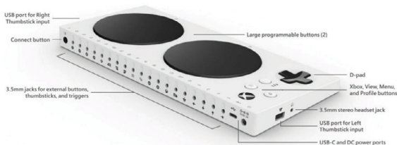
[Abb 1] Das modulare System des Microsoft Adaptive Controllers (Quelle: Braceworks, 2021)
