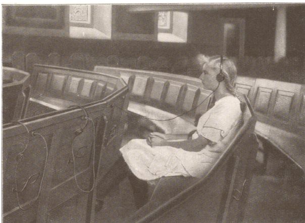
[Abb. 2] Vielhöranlage in der Neumünsterkirche in Zürich (1927).
