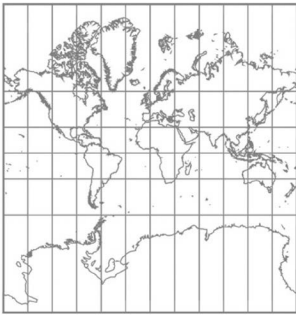
Abb. 27: Hier ist die Web-Mercator und die Mercatorprojektion überlagert, wobei in diesem Massstab die Formen identisch erscheinen. Battersby (2014, S. 3)
