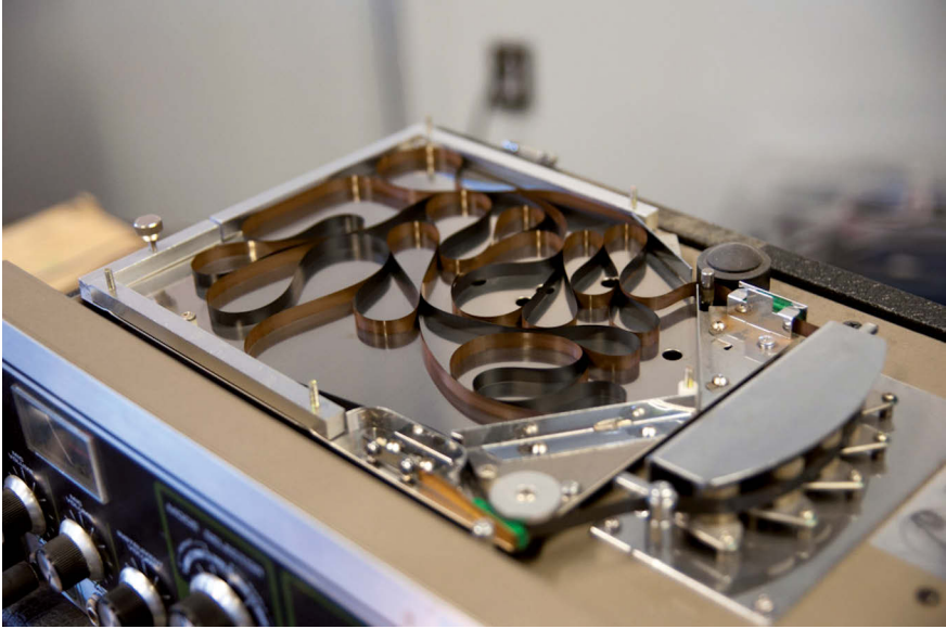
Abbildung 2: Tonbandschleife zum Erzeugen von Feedback und Echos im Roland RE-101 Space Echo, rechts sieht man fünf Aufnahme- und Wiedergabepunkte.
