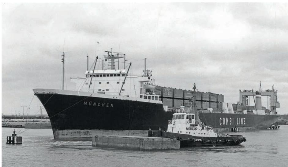
Abb. 15 Der LASH-Carrier MÜNCHEN in Bremerhaven, im Vordergrund bugsiert der Hapag-Lloyd-Schlepper MERCUR (1972) eine LASH-Barge. (Bremer Lagerhaus-Gesellschaft/BLG)
