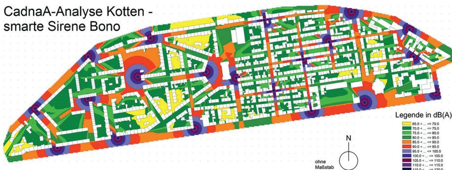
Abb. 3: Darstellung der CadnaA-Analyse zur flächenhaften Warnung des „Kotten“ durch das Sirenenmodell „Bono“ (Quelle: eigene Darstellung)
