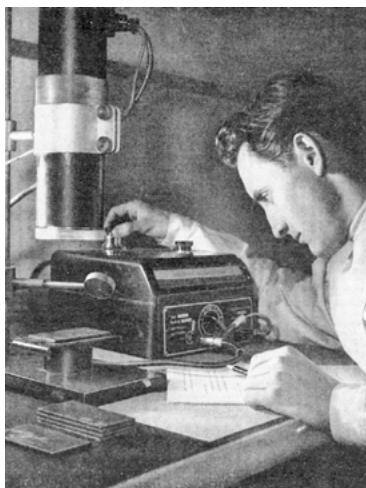
Abb. IV.2: Bestimmung der Dicke von Lackschichten durch Rückstrommessungen mit ^{204}\text{Thallium}
