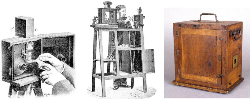
Abb. 2.1 & 2.2: Der Cinématographe der Brüder Lumière (1895). | Abb. 2.3: Der Theatrograph von Robert William Paul, modifiziert durch Méliès (1896).
