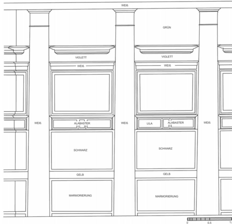
Abb. 40: Casa del Fauno, Südperistyl, Außenwand, Rekonstruktion (Anne Laidlaw).
