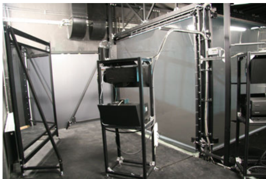
Abbildung 4: Aluminium-Tragkonstruktion der CAVE
