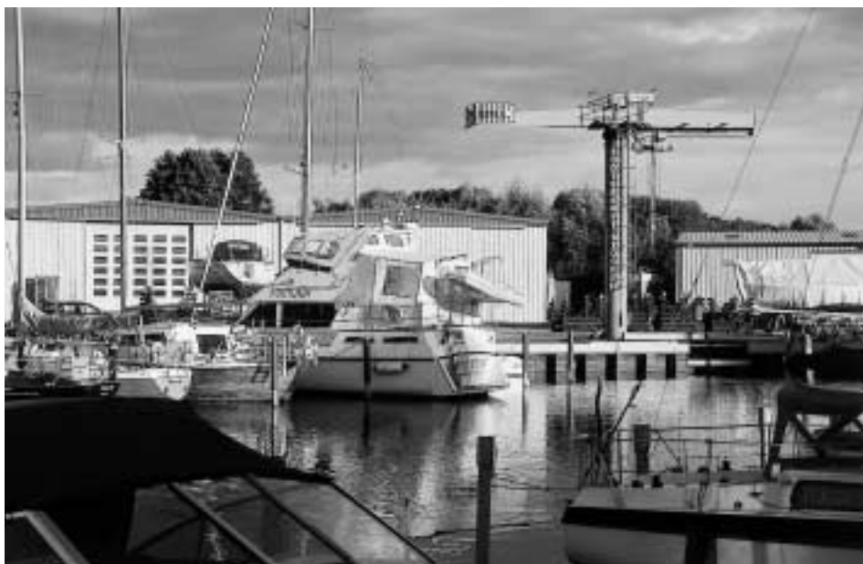
Abb. 8 Die Bootswerft Norbert Stöcker in Ueckermünde ist eine der seit 1990 modernisierten Werften: Ersatz der Slipanlagen durch einen Boots Kran, moderne Leichtbauhallen, Stahlspundwände anstelle hölzerner Bollwerkkonstruktionen, neue Steganlagen und erweiterte Liegeplätze.
