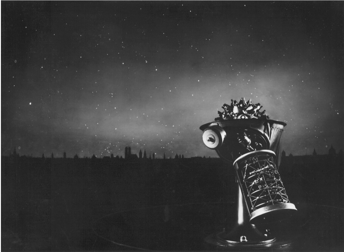
Abb. 2: Planetariumsprojektor der Firma Zeiss Modell I, im Hintergrund der Münchener Horizont.
