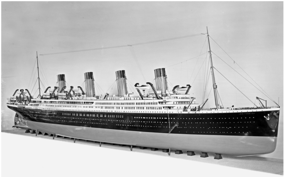
Abb. 15 Modell der BRITANNIC mit der ursprünglich vorgesehenen Aufstellung der optisch auffälligen Gitterdavits. Kriegsbedingt wurde das Schiff aber als Lazarettenschiff mit dem vorgeschriebenen Rotkreuzanstrich fertiggestellt. Die im Modell dargestellten beiden Davitpaare auf dem Achterschiff fielen dabei weg. (Ulster Folk and Transportation Museum, Belfast)
