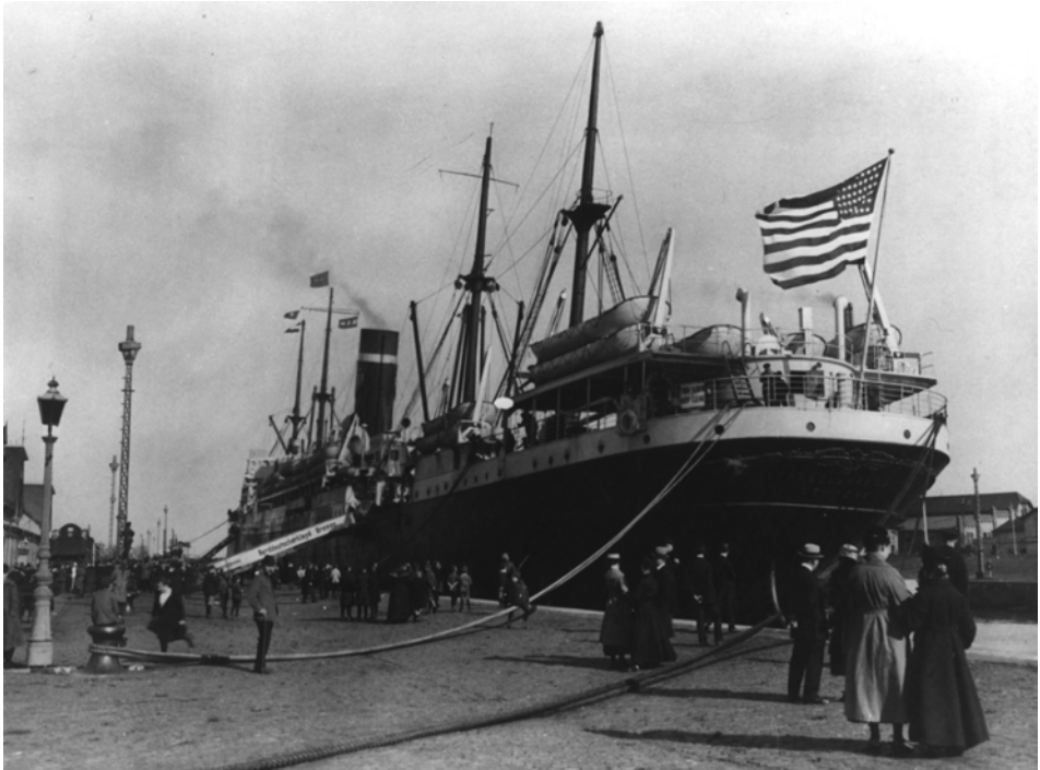
Abb. 21–22 Der amerikanische Fracht- und Passagierdampfer SUSQUEHANNA (ex RHEIN des Norddeutschen Lloyd, 1899, 10 058 BRT) in der Kaiserschleuse (oben) und an der Pier vor der Lloydhalle in Bremerhaven (unten). Deutlich ist die seitliche und achterliche Anordnung der Rettungsboote zu erkennen. (Archiv DSM)
