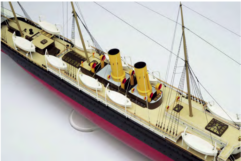
Abb. 8 Bootsaufstellung auf dem am 30. Januar 1895 in der Nordsee durch Kollision verloren gegangenen Lloyd-Schnelldampfer ELBE (1881, 4510 BRT). Das Modell im Deutschen Schiffahrtsmuseum zeigt das Schiff nach einem Umbau in seiner letzten Ausführung vor dem Untergang. (Foto: Egbert Laska, DSM)
