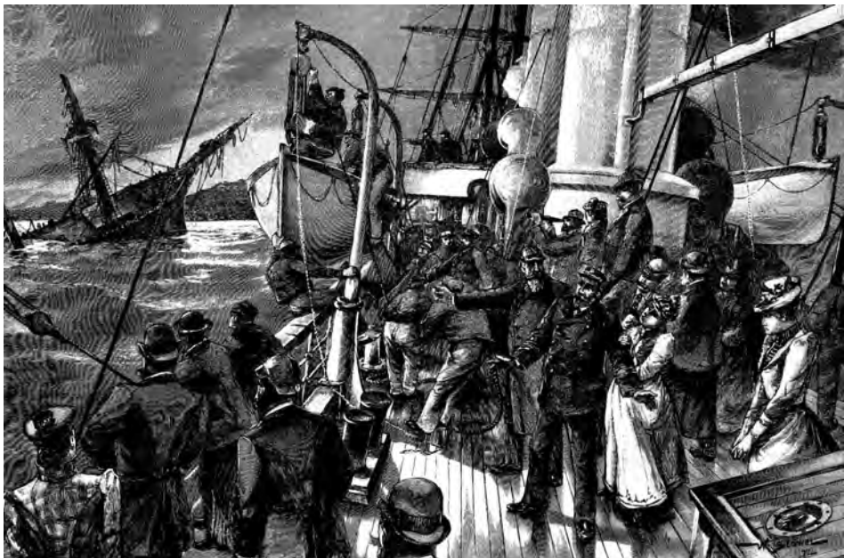
Abb. 10 Dieser Holzstich (1892) von Willy Stöwer illustriert die Umständlichkeiten des Aussetzens von Rettungsbooten mit herkömmlichen Drehdavits. (Archiv DSM)
