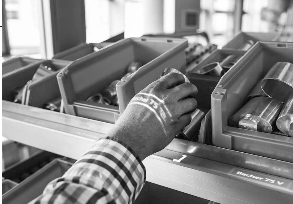
Moderne Montageassistenzsysteme, ausgestattet mit Bewegungserkennung, zeigen dem Arbeiter mittels Lichtmarkierung und Projektionen die nächsten Montageschritte an.
