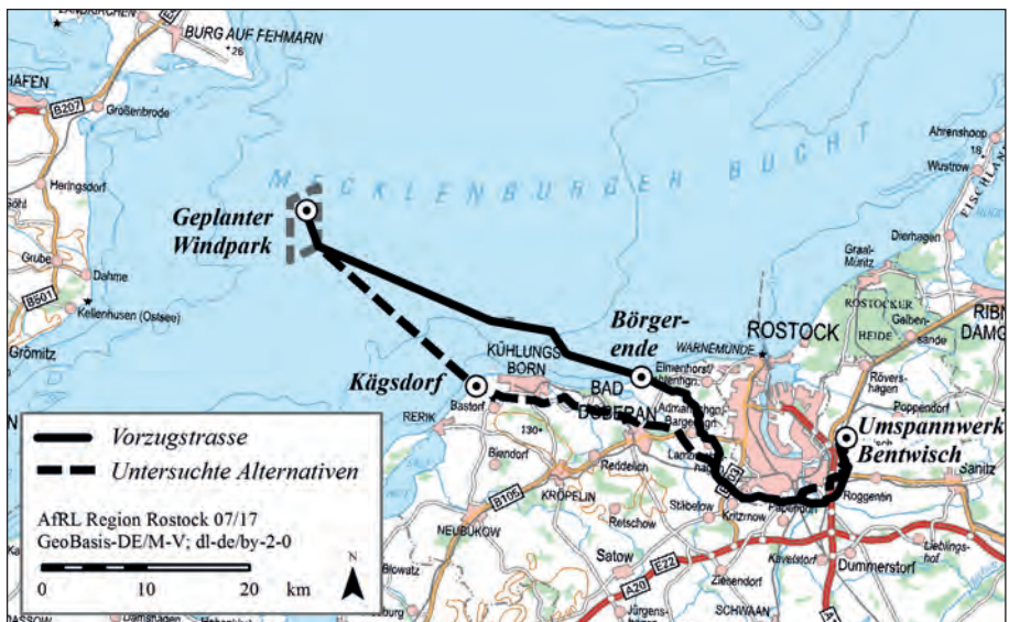
Abb. 1: Varianten im Raumordnungsverfahren für die Netzanbindung des Windparks „Beta Baltic“ / Quelle: Eigene Darstellung; Kartengrundlage: UEK 750
