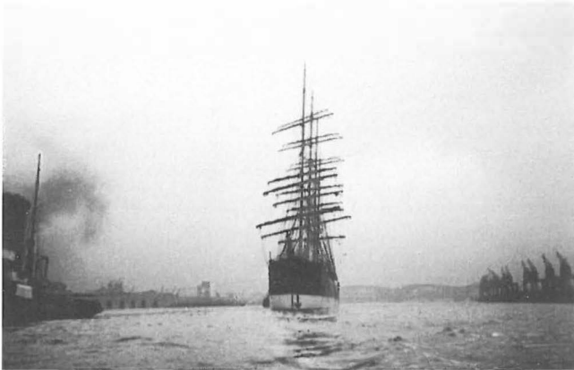
Die PADUA auf der Elbe, am Haken des Schleppers ADOLF. Die Royals wurden aus Stabilitätsgründen heruntergenommen
