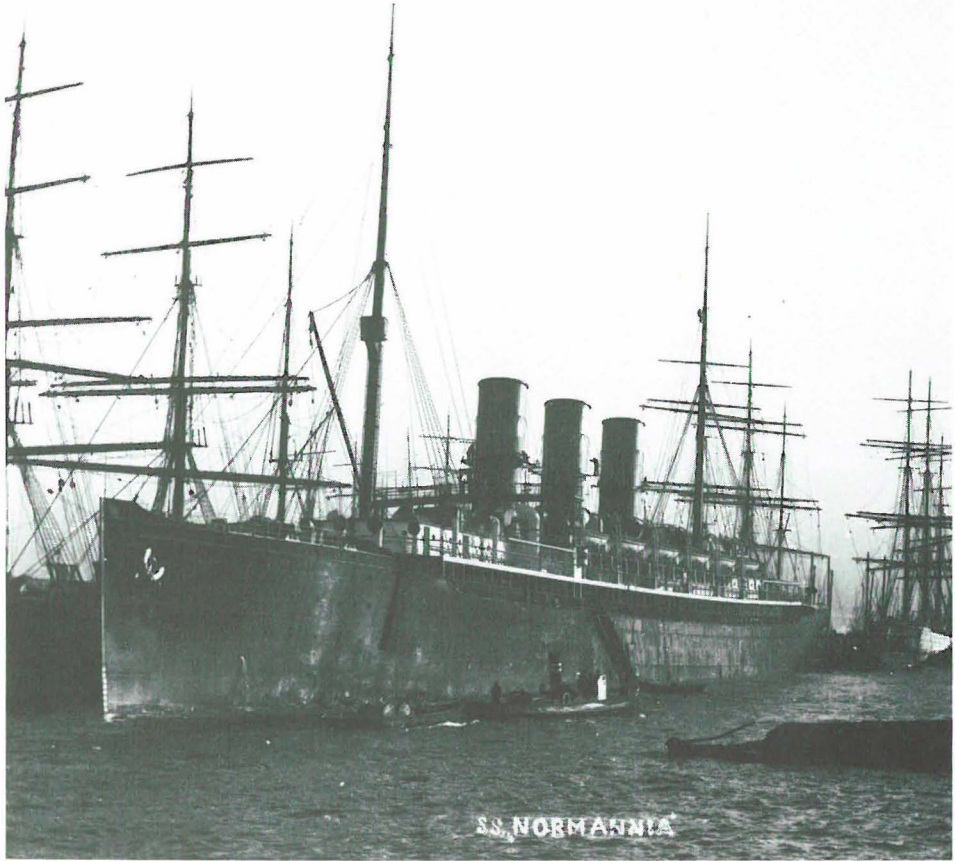
Die NORMANNIA im Hamburger Hafen bei Überholungsarbeiten. Besatzungsangehörige sind auf Stellagen mit dem Anstrich der Schornsteine beschäftigt. Die Dampfer der AUGUSTA-VICTORIA Klasse waren übrigens die ersten Hapag Schiffe mit gelben Schornsteinen, die bis 1902 exklusiv den Schnelldampfern vorbehalten blieben. (Foto J. Hamann)
