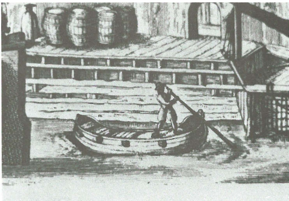
Abb. 11 Ausschnitt aus einem Stich von M. Deisch aus dem 18. Jahrhundert. Abgebildet ist der Gdańsker Hafen mit einem kleinen Verkehrsboot, das vier fest eingebaute Balken zur Querversteifung hat
