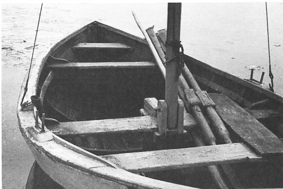
Abb. 14 Inneres eines Fischerbootes. Von links nach rechts: Zange, Riemen, Schwertflosse, Schanzkleid und Dollen
