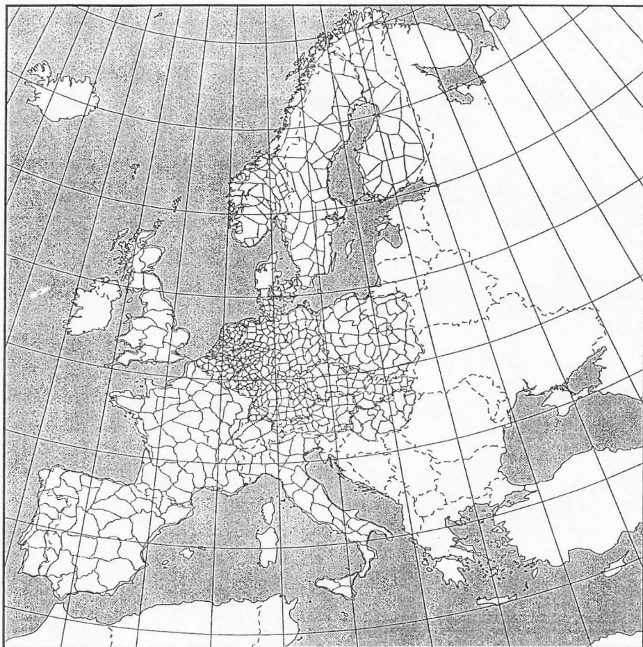
Abb. 6 Übersicht des Vereinigten Europäischen Nivellementnetzes (UELN). Das ursprünglich auf Westeuropa begrenzte UELN wird seit 1994 auf die osteuropäischen Staaten ausgedehnt. Die neuen UELN 95-Ergebnisse in Form von Normalhöhen beziehen sich auf den Amsterdamer Pegel. (Ibde 1997)
