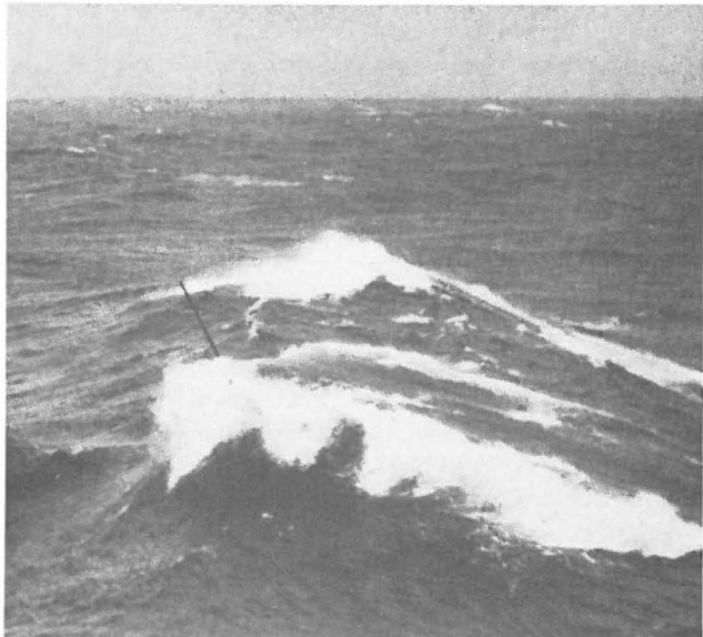
Eine verankerte Spiertonne zur Messung der Höhe von Wellen und Brechern.
