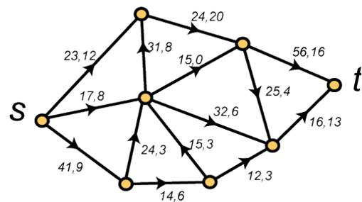
Além disso, um fluxo deve satisfazer a restrição de conservação de fluxo, ou seja, a quantidade de fluxo que entra em um vértice é a mesma que sai, com exceção de um nó fonte (denotado por  $s$ ), de onde só sai fluxo e um nó sorvedouro (denotado por  $t$ ) onde só entra fluxo. Formalmente, a rede de fluxo é sujeita às seguintes restrições:
