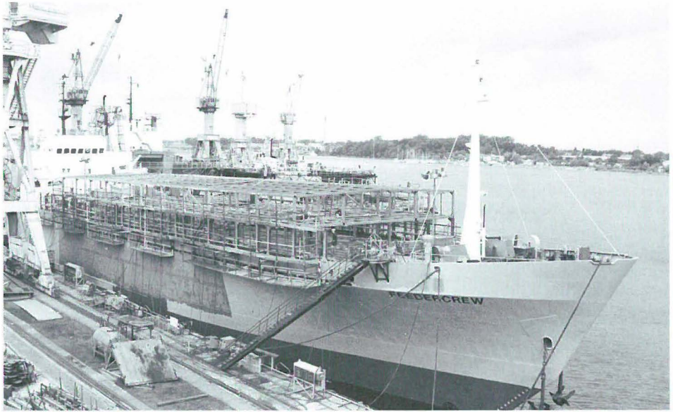
Umbau des MS FEEDERCREW zu einem Livestock Carrier im Standort Rostock, der ehemaligen Neptunwerft. Foto: Gudrun Bär
