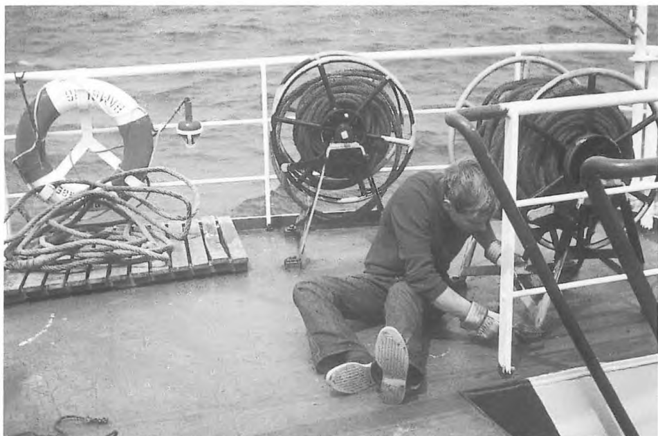
Die Trommeln mit den Festmacherdrähten werden entrostet.
