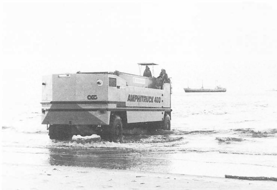
Abb. 23 Der Schwimmwagen »Amphitruck 400« übernimmt einen Container von einem auf Reede ankernden Schiff (a) und bringt ihn an Land (b) (1981).
