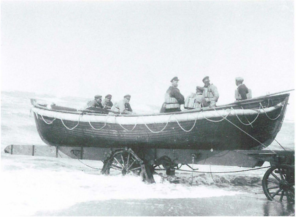
Das Strandrettungsboot wurde mit Pferden zum Strand gezogen und mit einer Wippe zu Wasser gelassen (oben und rechts). (Foto: Kubnigh)
