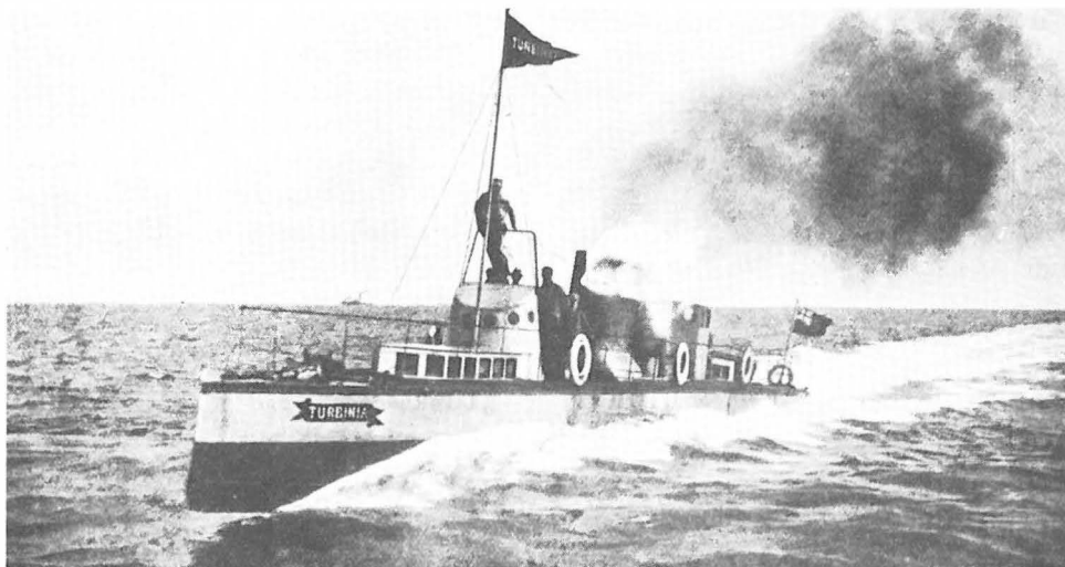
Das erste Turbinenschiff, die von Parsons erbaute „Turbinia“, Länge des Schiffs 100', Wasserverdrängung 44 1/2 t, Anlage mit 3 Propellerwellen zu je 3 Propellern, max. Geschwindigkeit 33 – 34 kn, erbaut 1897 (Foto: Neilson, The Steam Turbine , 1903).
