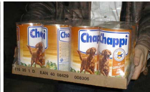
Stabil durch Foliensicherung
