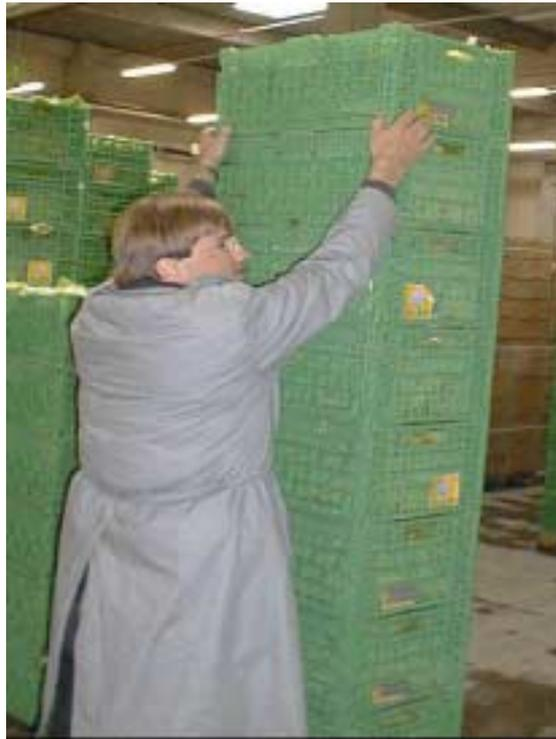
Diese Mehrbelastung versucht man zwar mit Technik auszugleichen, indem man Absetzgeräte einsetzt. Dies ist aber durch die Instabilität bei manchen Artikel nicht immer möglich. Ein Verbesserungsansatz wäre hier, z.B. eine Zwischenpalette bei den angelieferten Waren einzuziehen.
