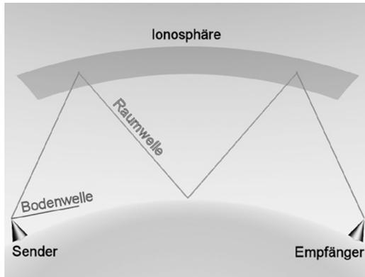
Abb. 17: Kurzwellenausbreitung: Abstrahlung einer oberflächennahen Bodenwelle und einer an der Ionosphäre mehrfach reflektierten Raumwelle (Multi-Hop)<sup>35</sup>
