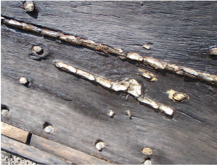
Abb. 22 Kalfatierung am Unterbord der Backbordseite. (Foto: archaeologie.de, Duisburg)
