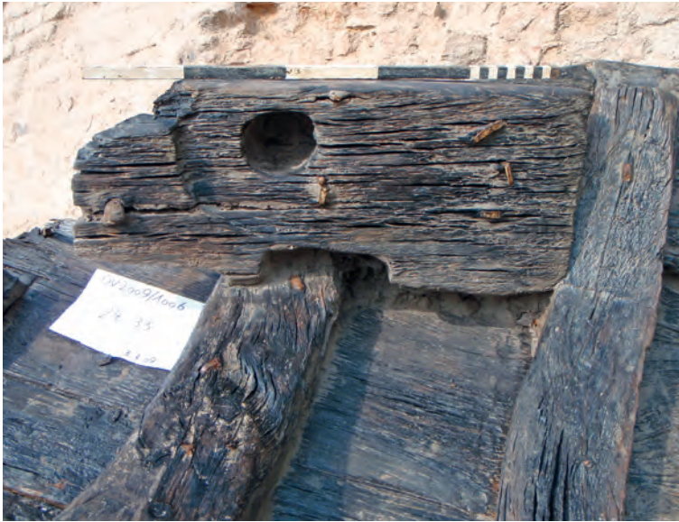
Abb. 27 Spillbacke des Brat-spills am Bug des Schiffes. (Foto: archaeologie.de, Duisburg)
