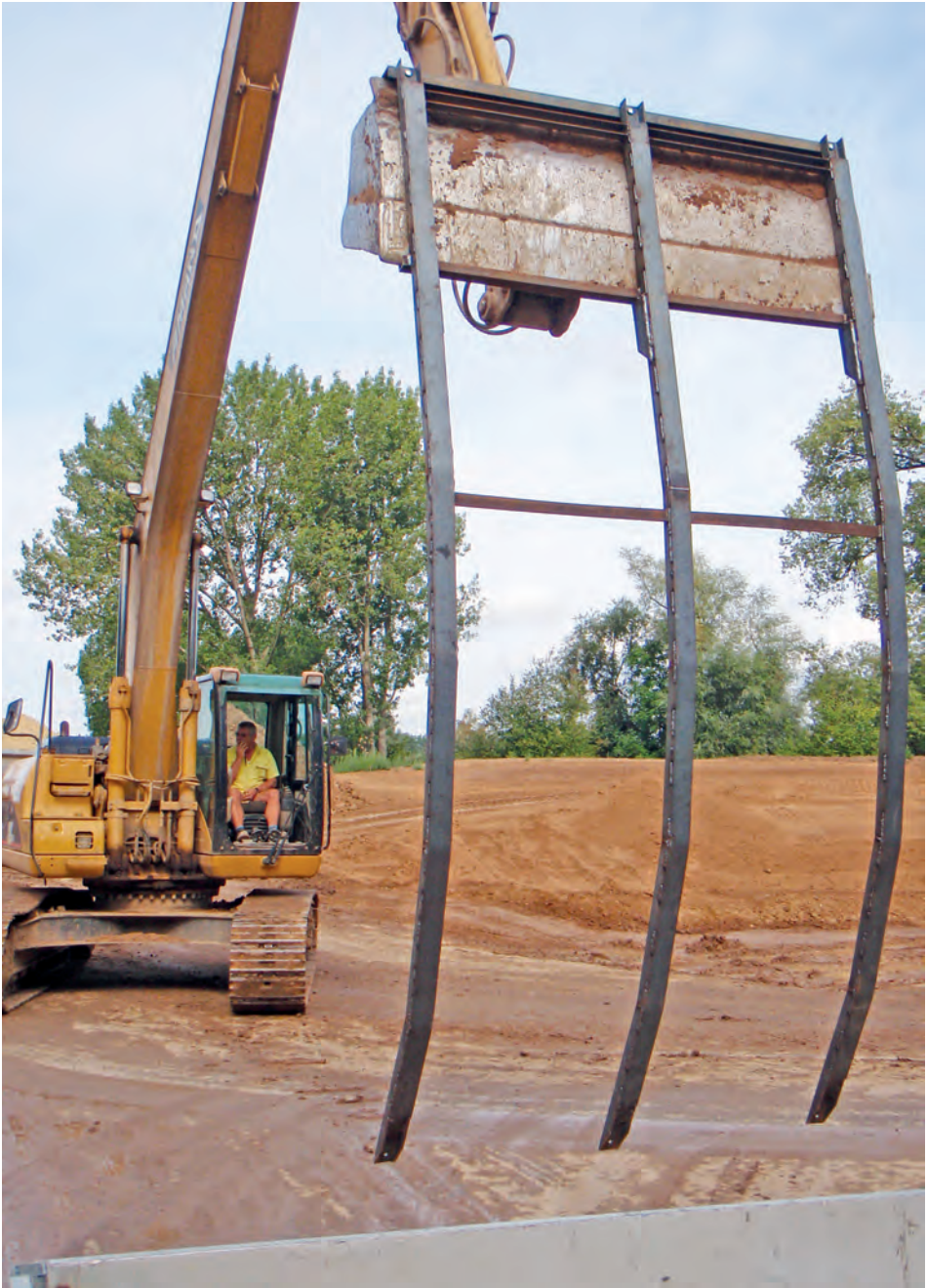
Abb. 10 Auf der Grabung entwickelte Hebevorrichtung zur Bergung der Rumpfsegmente, die teilweise unter dem Wasserspiegel lagen. (Foto: archaeologie.de, Duisburg)
