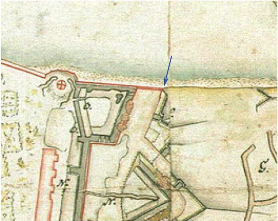
Abb. 17 Die Bastion St. Suitbert mit dem nördlichen Batardeau und seiner Anbindung an die äußeren Festungswerke (blauer Pfeil). Ausschnitt aus Abb. 1. (Hessisches Staatsarchiv Marburg)
