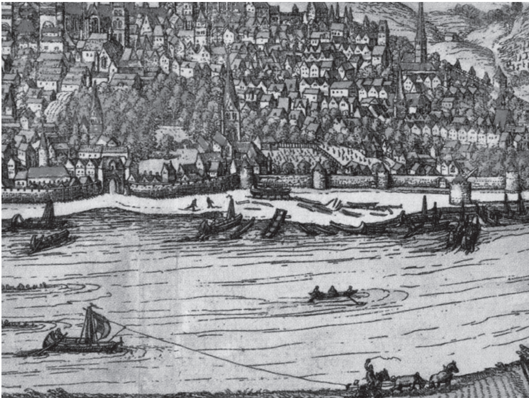
Abb. 5 Trierer Pferdetreidelszene mit besegeltm »Oberländer« (und backbords vertäutem kleineren ohne Segel?). Aus einer der ab 1572 erschienenen Auflagen von Braun, Hogenberg u.a.: Civitates Orbis Terrarum . Radierung, Ausschnitt. (Marit. Archiv d. Verf.)
