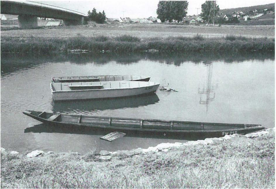
Abb. 9 Fischerschelch oberländischer Bauart in Hallstadt bei Bamberg mit der einzigen Ducht als Ruderbank in der hinteren Heb.
