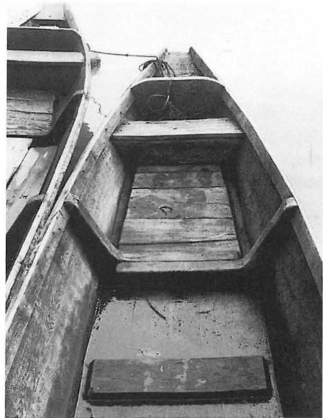
Abb. 11 Bodendoppelung im Bereich der hinteren Heb zwischen letztem Spantpaar und Ruderbank.
