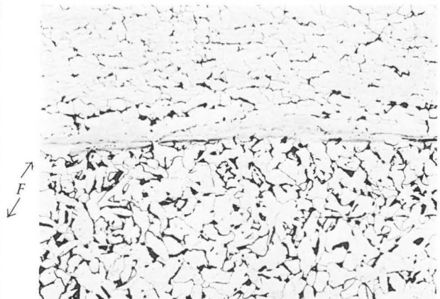
Abb. 12 (links) Randpartie von Klammer B mit tiefer Korrosionsgrube, die nur bis zu einer Schweißnaht F reicht. Im unteren Teil Kristallseigerungen. Interferenz-Phasenkontrast. (M. 90:1; Ätzung: 2% alkohol. HNO_3 ).
