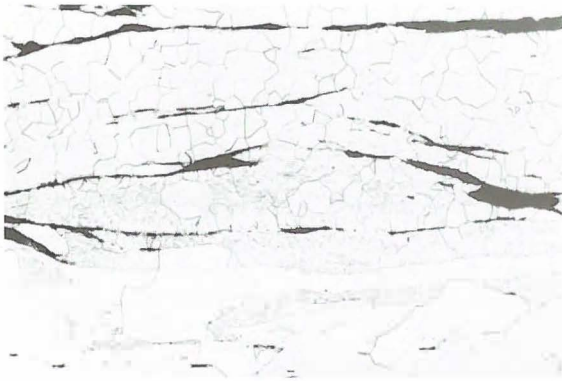
Abb. 14 (links) Gefüge unterschiedlicher Korngröße bei Klammer C mit Schlackeneinschlüssen. (M. 70:1); Ätzung: 2% alkohol. \text{HN}\bullet_3 .
