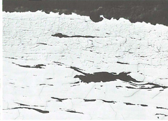
Abb. 8 (links) Ferritisches Rand- und Kerngefüge von Klammer A. (M. 70:1; Ätzung: 2% alkohol. HNO_3 ).
