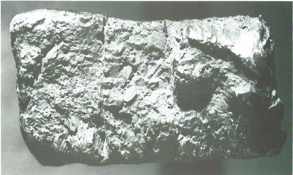
Abb. 7a Bruchstelle des Ankerschaftes. (Foto: Meierdierks/DSM)
