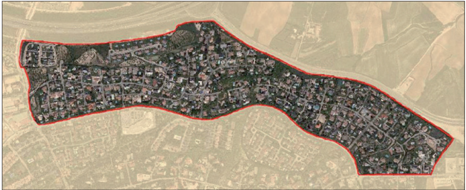
Abb. 2: SIOSE, Beispiel für den beschreibenden Ansatz: Das Polygon mit der Landbedeckungsart „Nichtdurchgängige Städtische Prägung (CORINE Klasse 1.1.2)“ enthält als Landbedeckungselemente: 50 % Gebäude, 15 % Verkehrswege, 20 % Bäume, 10 % krautige Vegetation, 5 % Schwimmbäder. (Quelle: Villa 2009; Instituto Geográfico Nacional)
