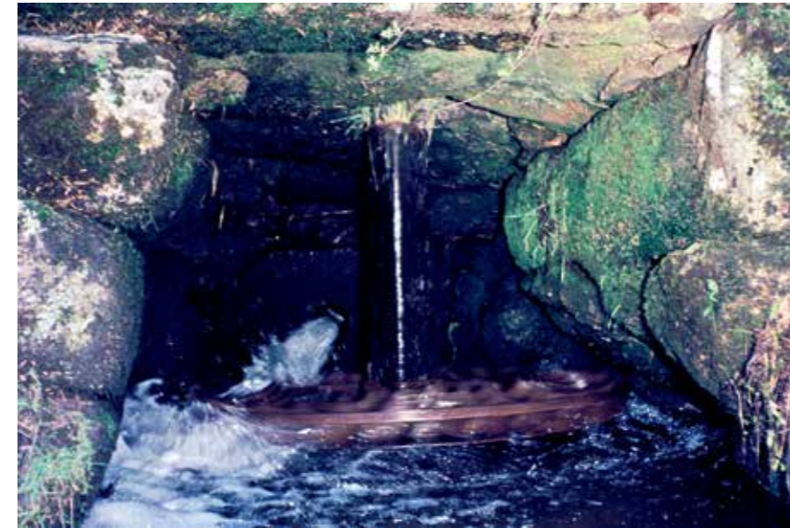
Unterer Teil einer Mühle: Seitlich angestoßenes Schaufelrad ( rodízio ) und senkrechte Achse zur direkten Kraftübertragung auf einen darüber rotierenden Mühlstein. Peirezes/Chã, Montalegre, April 1966.
